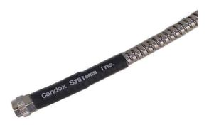
柔軟な測定用5B-065ケーブルをステンレスチューに被せて強化したアーマードケーブルです。 5B-055Aより細身で取り回し重視の用途に。 ~40GHz (2.92mmコネクタ) 繰り返しの曲げや取り回しのある現場。 恒温槽での使用。 屋外フィールドでの使用、等。
